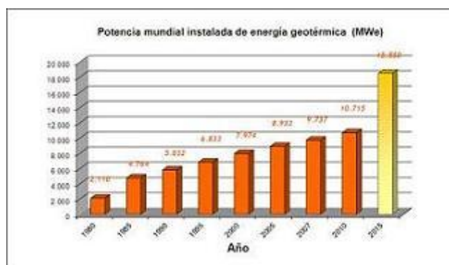
Figura 4.6.1. Evolución de potencia mundial instalada de energía geotérmica para producción de electricidad
