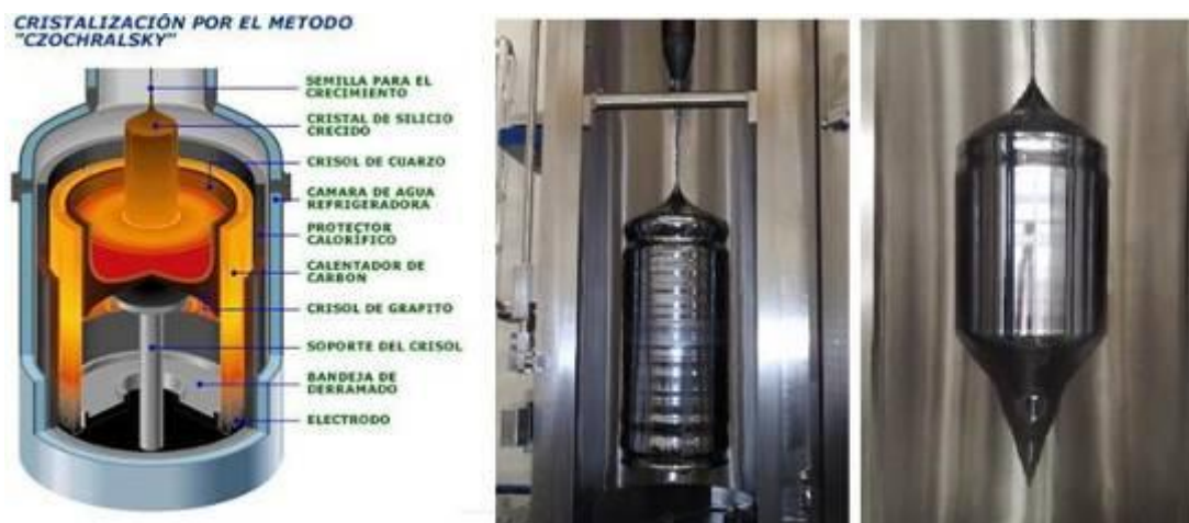
Figura 4.9.7. Cristalización por método Czochralsky
