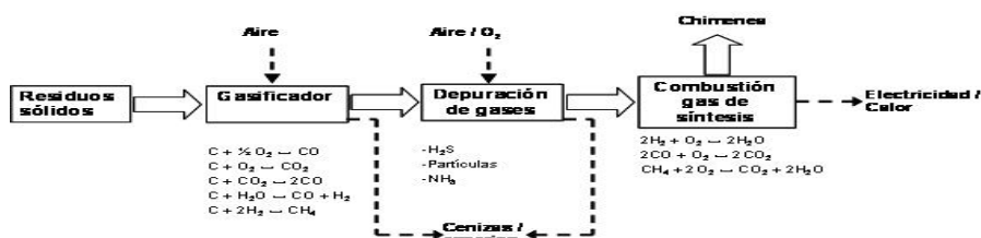
Figura 4.8.9. Proceso de gasificación de residuos
